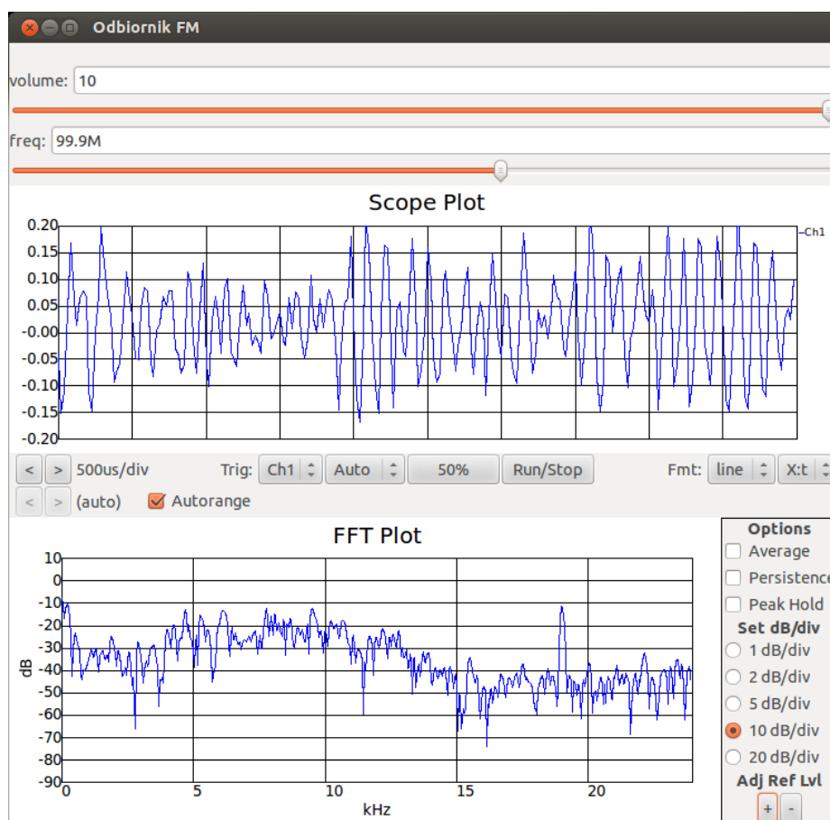
Rys. 9. Interfejs umożliwiający odbiór oraz analizę sygnałów radiowych FM uzyskany w środowisku GRC.
